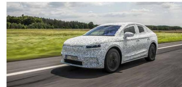
putem jednostepenog menjača. ENYAQ COUPÉ iV 80 takođe ima pogon na zadnje točkove, pogonjen elektromotorom snage 150 kW\*. Kad je opremljen većim akumulatorom od 82 kWh (neto 77 kWh) i zahvaljujući izvrsnoj aerodinamici automobila s koeficijentom otpora vazduha (cd) od 0,247, ova varijanta može preći više od 535 km - stoga nudi najveću kilometražu unutar raspona modela.
