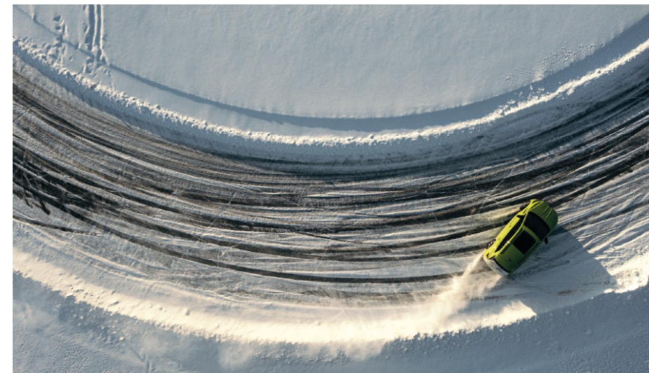
245/35-R20 „event tyres“ (iz Michelina) napred su imale 600 klinova od 5 mm, što je omogućilo još bolju vuču i upravljanje na zaledenoj površini bez prijanjanja; dok su gume Nokian Hakkapelitta 255/45-R20 postavljene na zadnje točkove imale 300 klinova od 2 mm po površini gume, što se pokazalo idealnom kombinacijom na 40 cm dubokoj ledenoj površini.
